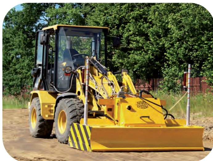
Przystawka równająca leveller zainstalowana na małej ładowarce.
